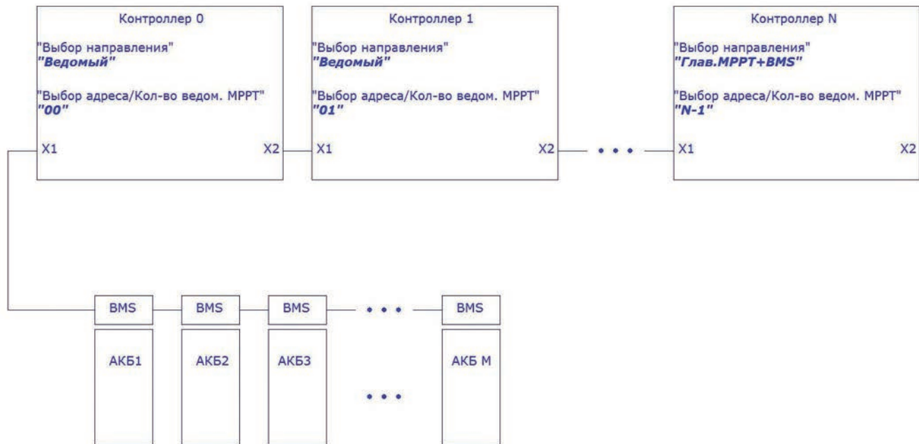
Рис. 3. Схема системы «Несколько Контроллеров+BMS».
